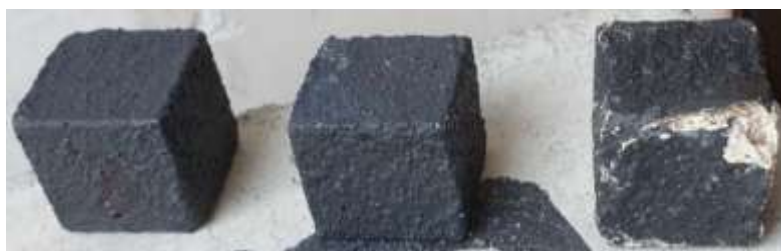
Рисунок 2 - Кубики, экспонированные в течение 7 дней (слева на право) в нейтральной (вода), щелочной (0,1н NaOH) и кислой (3% H 2 SO 4 ) средах.
