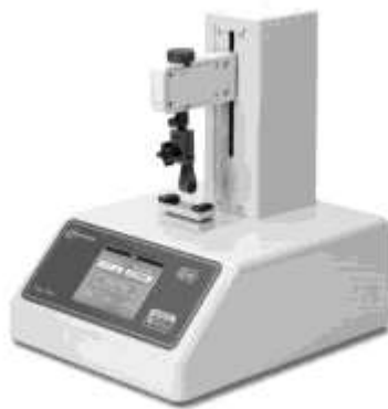
Рисунок 7 - Прибор Loop Task 2000 (LT-2000) – используется для определения петлевой липкости самоклеящихся материалов [2]
