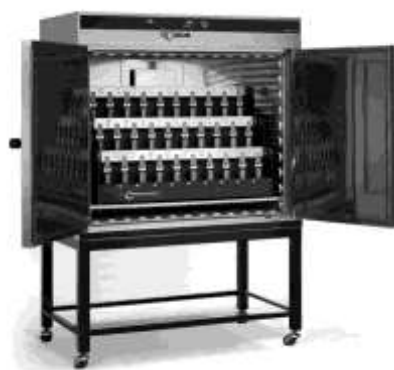
Рисунок 8 - Испытательное оборудование для определения статического сдвига в т.ч. и при повышенных температурах SS-OS-30 [2]
